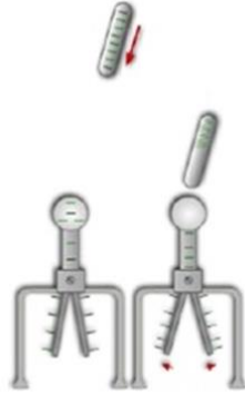
Yüklü bir elektroskop yükünden küçük olan bir cismin elektroskop yapraklarına etkisi
