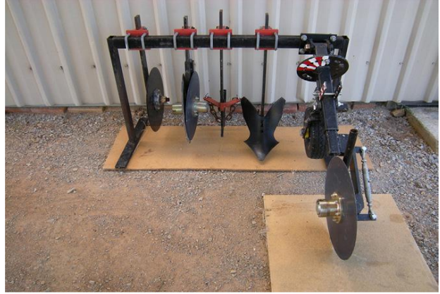
Resim 2. İki tekerlekli traktörle çekilen doğrudan ekim makinesi (Fotoğraf: R.J. Esdaile).
