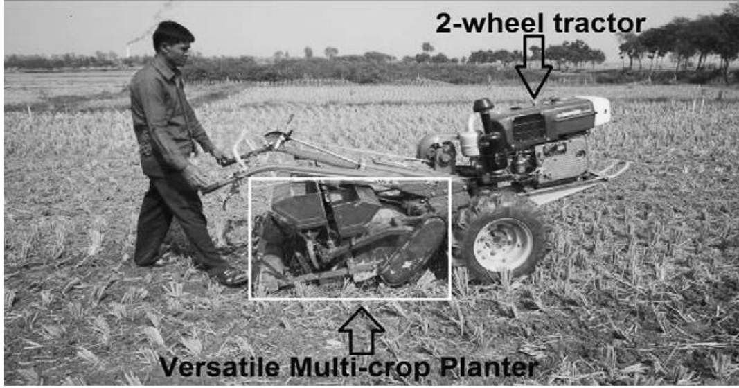
Resim 3. İki tekerlekli traktöre monte edilen çok yönlü ekici (Fotoğraf: M.E. Haque).
