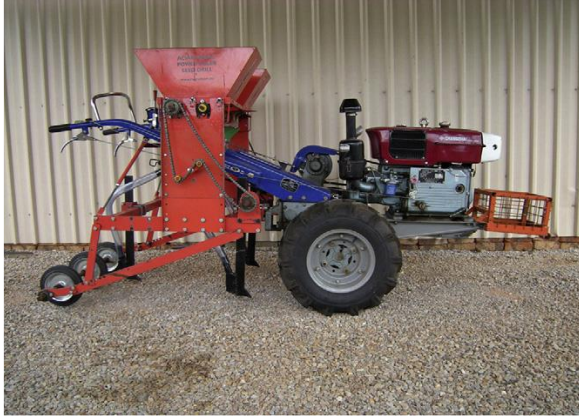
Resim 2. İki tekerlekli traktörle çekilen doğrudan ekim makinesi (Fotoğraf: R.J. Esdaile).
