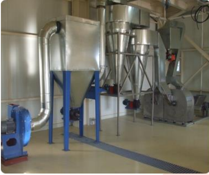
Foto. 3a. Pnömatik (Flash) kurutma makinesinin genel görünümü ve avantajları.
