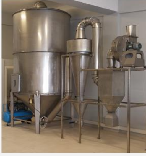
Foto. 4. Püskürtmeli Kurutucu (Sprey Dryer) kurutma makinesinin genel görünümü ve avantajları.
