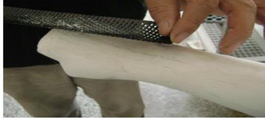
Şekil 2.13: Alçı modelin raspalanması
