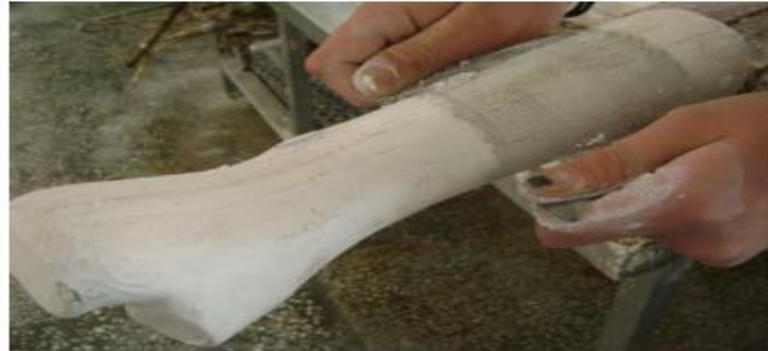
Şekil 2.14: Alçı modelin pürüzlerinin tellenmesi
